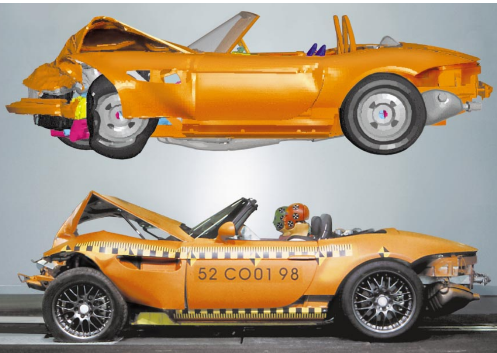
Bild 12: Übereinstimmung der Crashsimulation zum Realcrash bei 64 km/h gegen eine deformierbare Barriere
