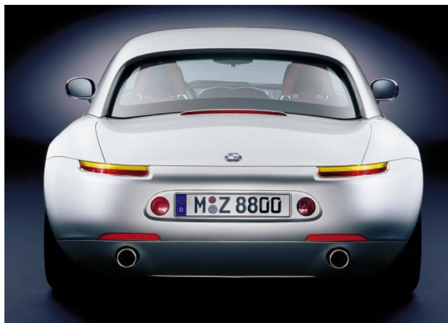
Bild 24: Leuchteinheiten hinten mit Fahrtrichtungsanzeiger; Rück- und Bremsleuchten in Neontechnik, Nebelschluss- und Rückfahrleuchte
